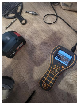
Utført kontroll i tilliggende konstruksjon - Fuktmåling
