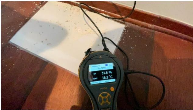
Bilde viser måling av luftfuktighet (RF)
