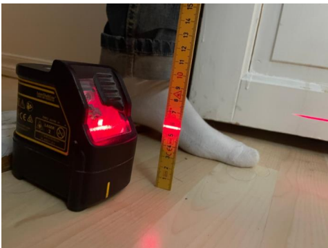
Bildet viser måling av høyde på gulv ved laser (2.etg.)
