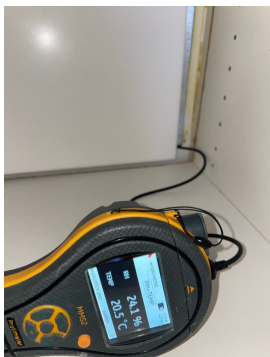
Bilde viser måling av luftfuktighet (RF)
