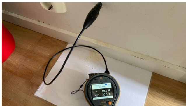
Bildet viser måling av luftfuktighet (RF).
