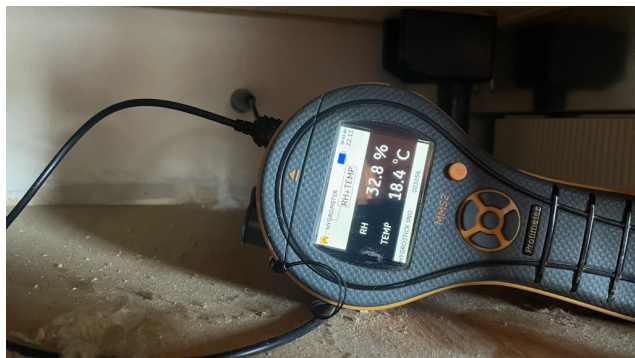
Bildet viser måling av luftfuktighet (RF).
