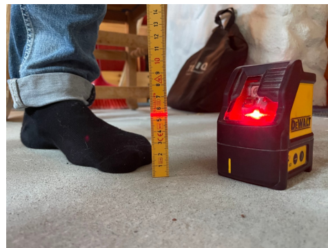
Bildet viser måling av gulv ved laser.
