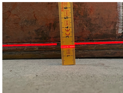
Bildet viser måling av gulv 2 meter fra laser.
