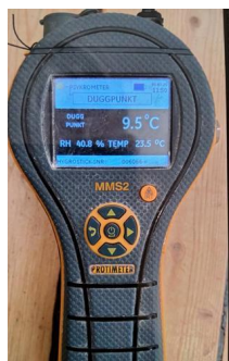
Utført kontroll i tilliggende konstruksjon - Fuktmåling
