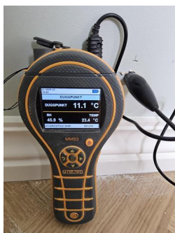
Utført kontroll i tiliggende konstruksjon - Fuktmåling
