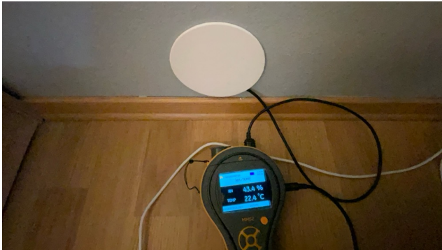
Bildet viser måling av luftfuktighet (RF)
