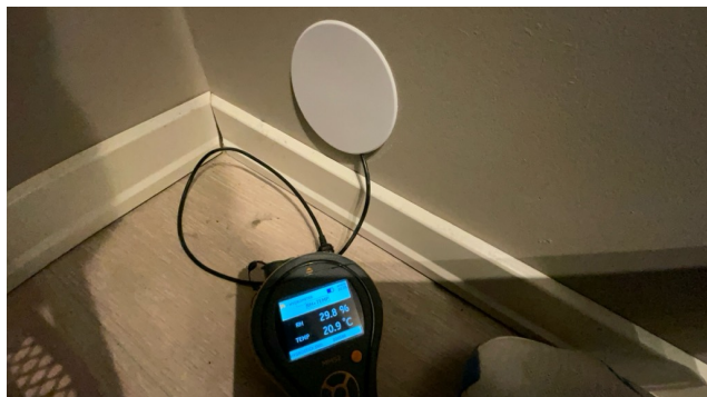
Bilde viser måling av luftfuktighet (RF)
