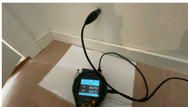
Bilde viser måling av luftfuktighet (RF)
