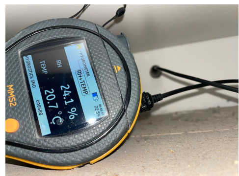
Bilde viser måling av luftfuktighet (RF)
