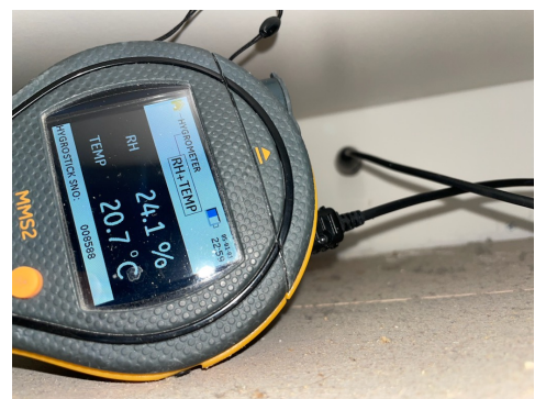
Bilde viser måling av luftfuktighet (RF)
